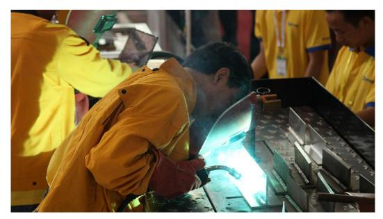
CO<sub>2</sub>气体保护焊是 50 年代发展起来的一种新的焊接技术。半个世纪以来,它已发展成为一种重要的熔焊方法。广泛应用于汽车工业,工程机械制造业,造船业,机车制造业,电梯制造业,锅炉压力容器制造业,各种金属结构和金属加工机械的生产。
